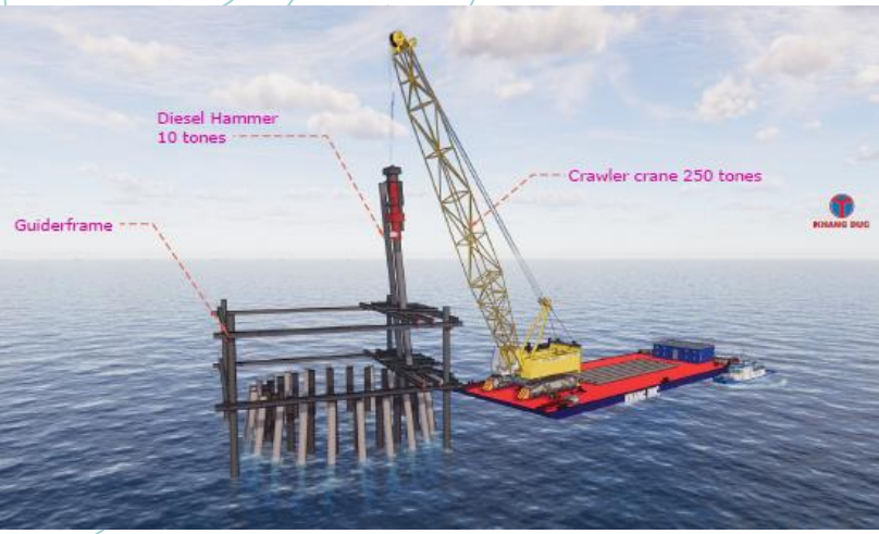
Đóng cọc PHC D800mm
